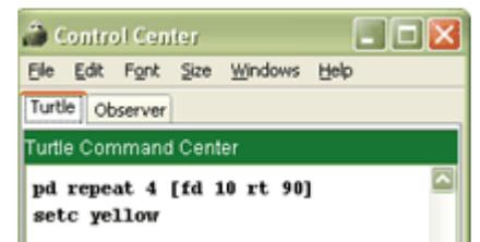
**Nota:** A cor do traço desenhado pela tartaruga é a sua própria cor. Podes, com o comando `setc` (= *set color = escolher cor*) alterar a cor da tartaruga e, portanto, a cor do traço por ela desenhado.
